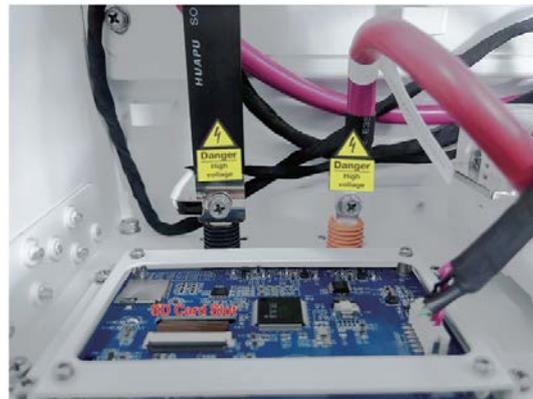
Hinweis: Wenn Sie die SD-Karte einlegen, ziehen Sie das Batteriestromkabel ab und schalten Sie den Luftschalter manuell in die Aus-Position.
